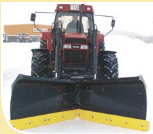
Model VP ve tvaru písmene „Y“. Hrany ocelového břitu jsou zaobleny (tzv. „chodníková ocel“), což zvyšuje životnost břitu při najetí pluhu na chodník či jinou překážku.
