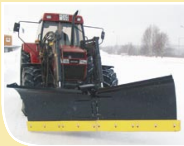
Model VP je uložen na centrálním čepu. Toto uložení umožňuje pluhu kopírovat nerovnoměrné povrchy. To zabezpečuje čistější povrch, snížení poškození pluhovaného povrchu a zajišťuje rovnoměrné opotřebení břitu.
