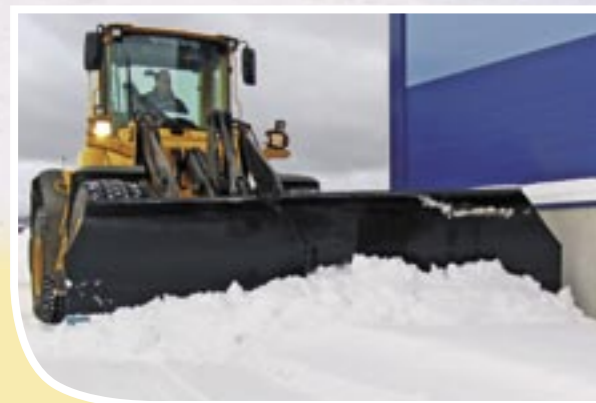
Sněhové pluhly OPTIMAL jsou konstruovány a vyráběny švédskou společností TREJON. Společnost TREJON vyrábí sněhové pluhly OPTIMAL ve dvou různých řadách s pracovním záběrem od 190 do 400 cm.
