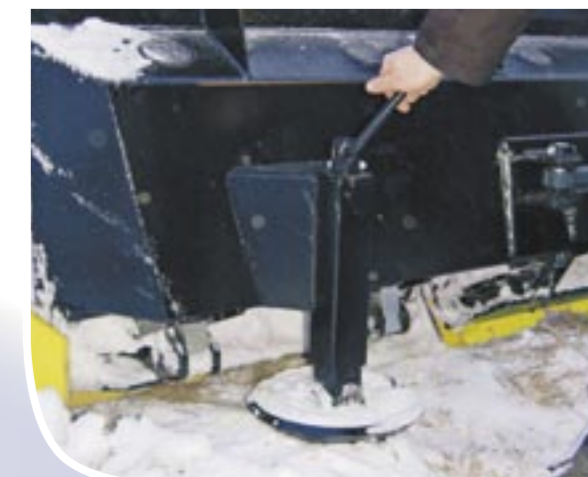
Kluzák lze nastavit manuálně. Pružný břit se zaklopí při njetí na chodník či jiný pevný objekt.
