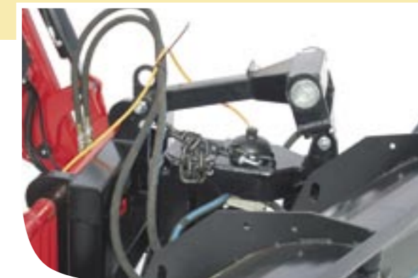
Funkce FlexiMove™ umožňuje, aby pluh kopíroval povrch. Pomocí této funkce lze měnit tlak na povrchu.
