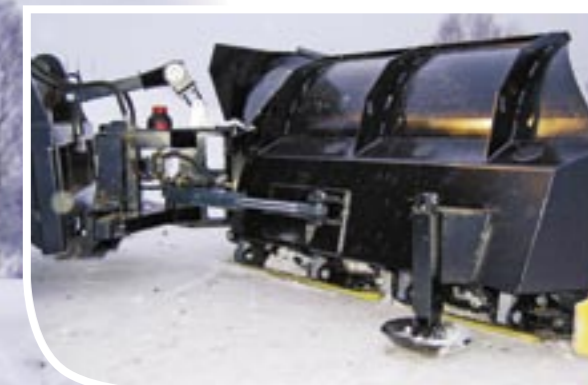
Modely VPT jsou vybaveny diagonálním rozvaděčem pro ovládání obou křídel současně.
